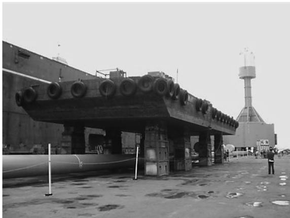
図4 設置航海出発直前の海洋肥沃化装置「拓海」（手前に伸びているパイプが海洋深層水取水管）
