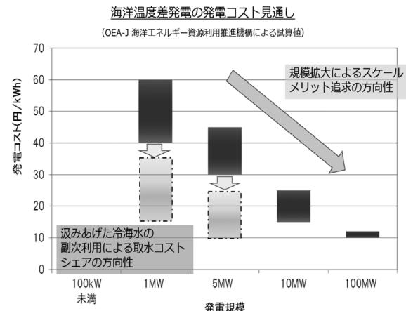
図4. 海洋温度差発電の発電コストと海洋深層水利用
