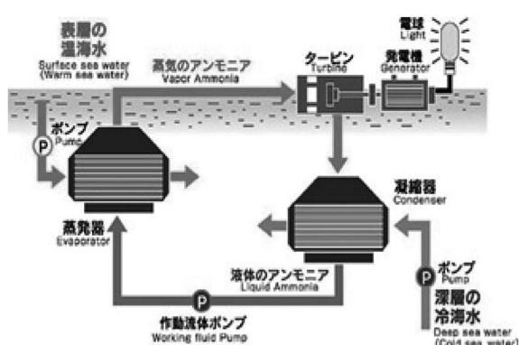
図1. 海洋温度差発電の原理
