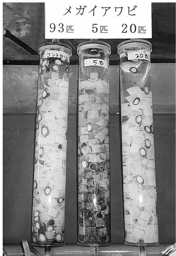
図4. 内径70mm長さ500mmのアクリル製透明パイプに短く切断したビニールチューブを付着基盤として収容したバイオリアクターにDSWを連続的に供給して付着珪藻とメガイアワビを同時に培養したときの様子。リアクターにアワビを93個体(コントロール:左)5個体(中),20個体(右)それぞれ収容した。93個体収容したリアクター内部には付着珪藻がアワビにより食いつくされてほとんど存在していない。
